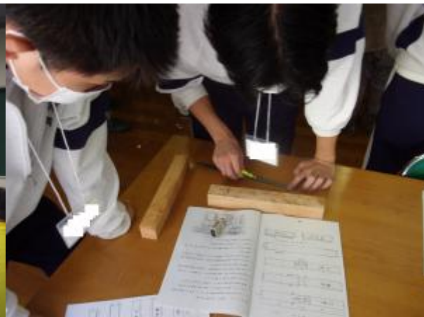
2 資料の図面をもとに檜木の材料に設計図の墨付けを行う。
