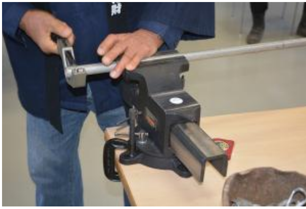
1 パイプカッターでパイプを切断
