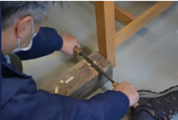
4 真竹の皮を残して削る
