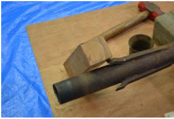
1 コシタとなる木材に削る輪郭を写す。
