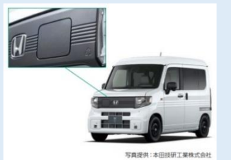
電気自動車 N-VAN e: のフロントグリルへの再生プラスチック利用
