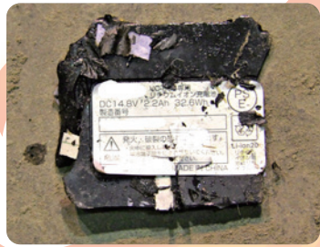
▲クリーンセンター内火災の原因とみられるリチウムイオン電池
