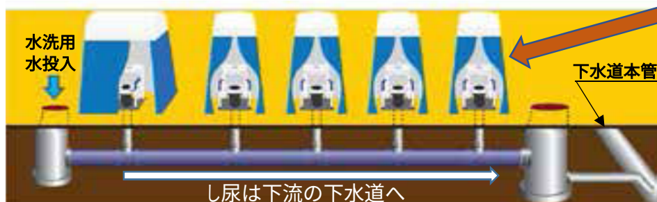
マンホールトイレの仕組み
