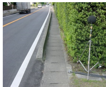
写真 道路における騒音・振動調査
