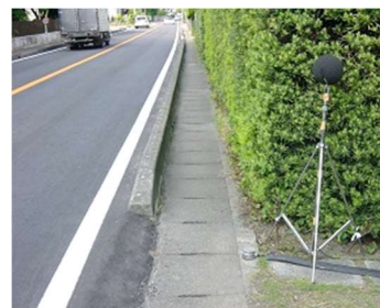
写真 道路における騒音・振動調査
