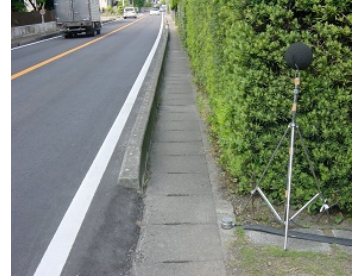
写真 道路における騒音・振動調査
